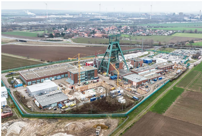
Abb. 1: Schachtanlage Konrad; links: Luftbild Schacht Konrad 1; rechts: Ausbau des ehemaligen Eisenerzbergwerks zum Endlager für radioaktive Abfälle mit vernachlässigbarer Wärmeentwicklung. [8]
