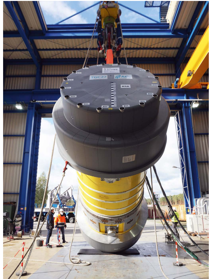
Abb. 1: Vorbereitung Fallprüfung eines 120 t Behälters auf IAEO-Fundament.
